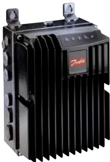
VLT® серии Decentral FCD 300 – это полноценный преобразователь частоты, предназначенный для децентрализованной установки. FCD 300 может быть установлен на стене в непосредственной близости от двигателя или на самом двигателе. FCD 300 имеет корпус со степенью защиты IP66.
